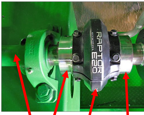
FAN SHAFT HUB ELEMENT HUB
